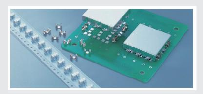
デジタルメディア製品の機器内部に使用されているシールドケースを 固定するために開発された小型端子です。この製品を使用すること により、従来手付け半田により行われていたシールドケースの取付け 作業が、ワンタッチで行うことが可能となります。
