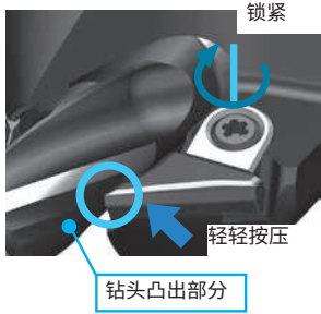
Fig. 5 紧固刀片
